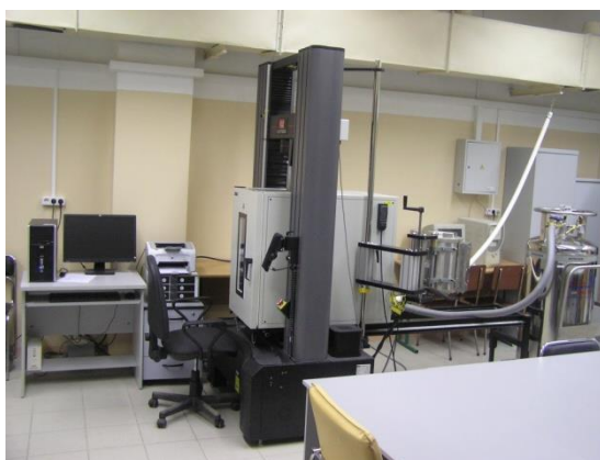
Рис. 1. Испытательная машина INSTRON 5982 с климатической камерой Instron-SFT 3119
